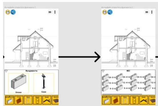
Рисунок 2- Интерфейс открытого фрагмента - выбор конструктивной схемы фундамента
